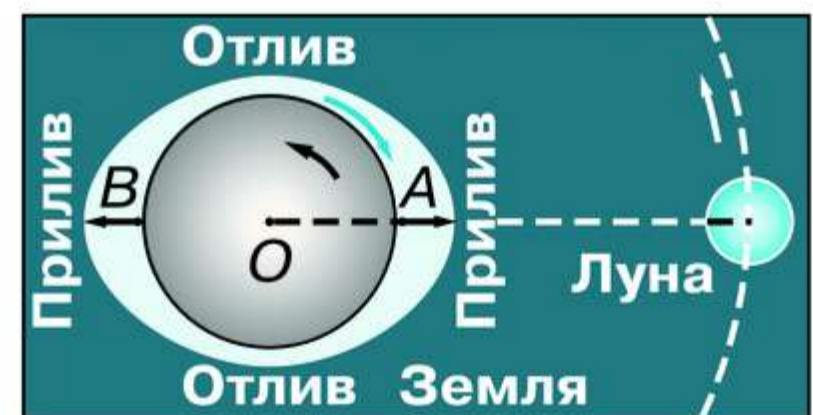
Рис. 3.13. Схема лунных приливов
