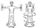
Рис. 7.15. Демонстрация закона сохранения момента импульса с помощью скамьи Жуковского. В силу закона сохранения момента импульса, студент, прижимая к себе гантели, начинает вращаться быстрее,
