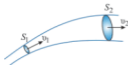
Рис. 9.4. Течение жидкости по трубе. Сечения трубы S_1 и S_2 различны, поэтому и скорость v_1 и v_2 в этих сечениях неодинакова
