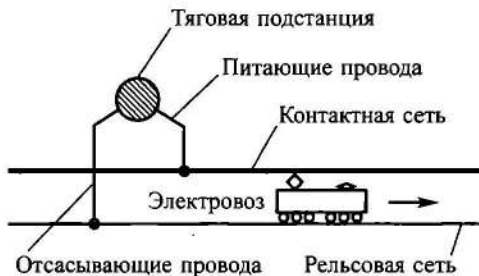
Рис. 1.2.3. Принципиальная схема тяговой сети
