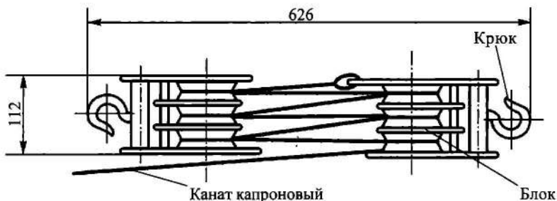
Рис. 11.3.4. Полиспаст монтажный грузоподъемностью 1,0 тс
