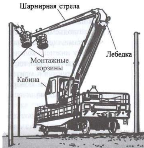
Рис. 11.2.1. Машина с шарнирной стрелой МШТС-2ПМ на железнодорожной платформе
