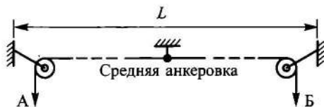
Рис. 2.6.5. Схема двусторонней компенсации провода со средней анкеровкой
