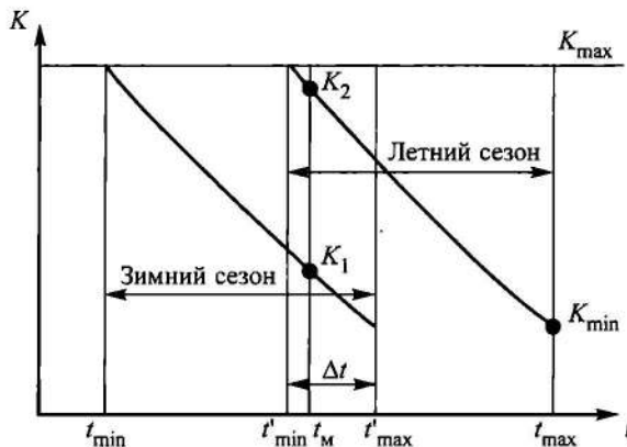
Рис. 2.2.2. График изменения натяжения контактного провода при сезонной регулировке
