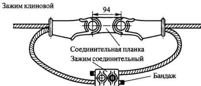
Рис. 5.4.2. Стыкование сталемедных проводов
