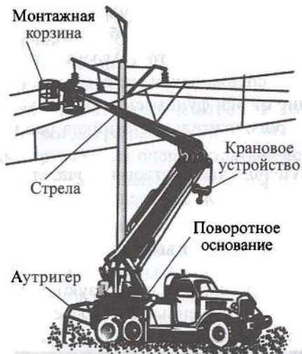
Рис. 11.2.2. Машина с шарнирной стрелой МШТС-2А на автоходу
