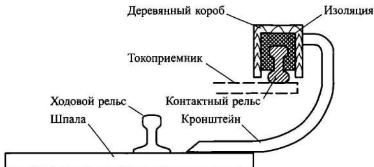
Рис. 1.3.1. Схема расположения контактного рельса на метрополитене
