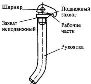
Рис. 11.3.12. Ключ для рихтовки контактного провода
