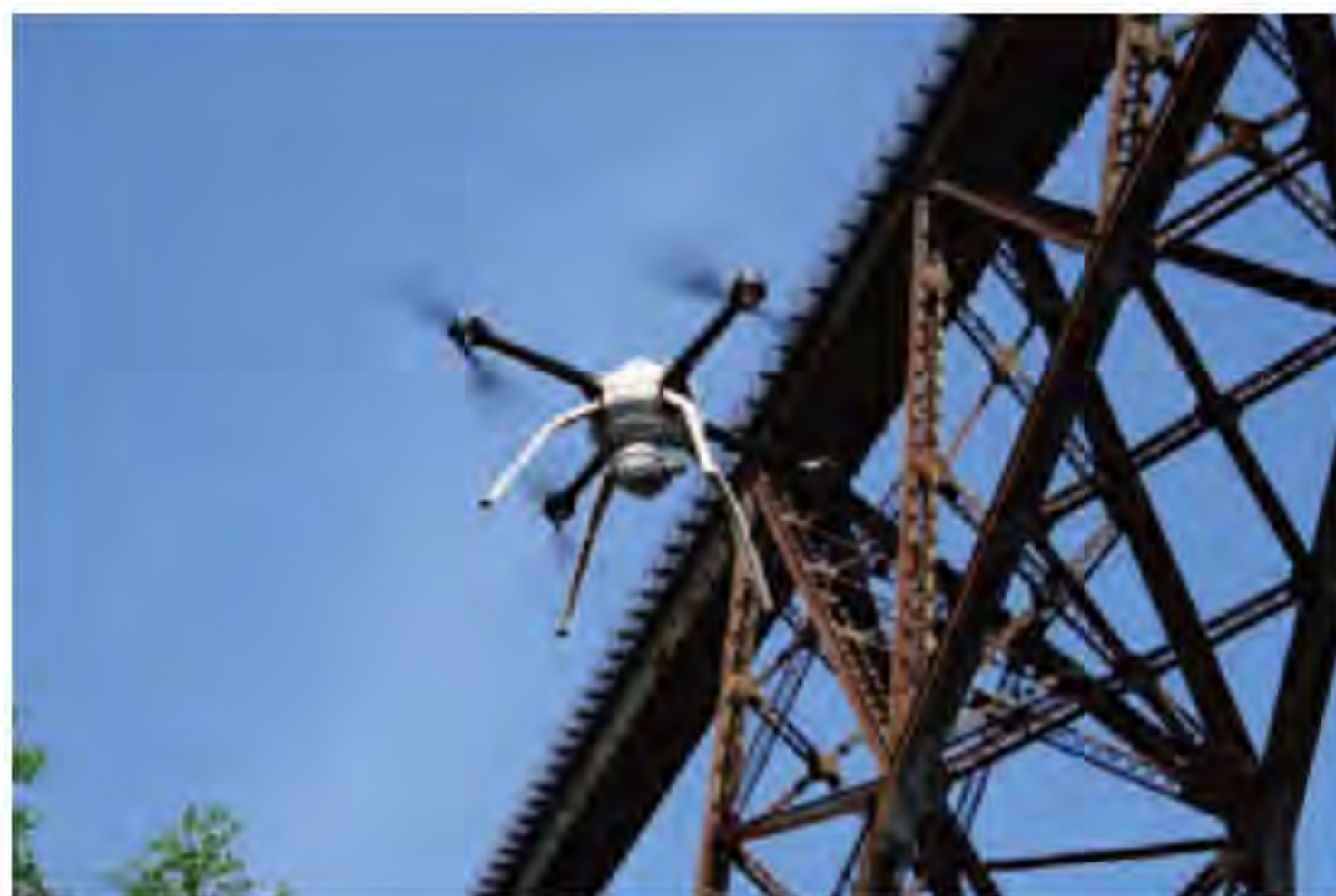
Рис. 1. Использование дрона для осмотра мостовых конструкций
