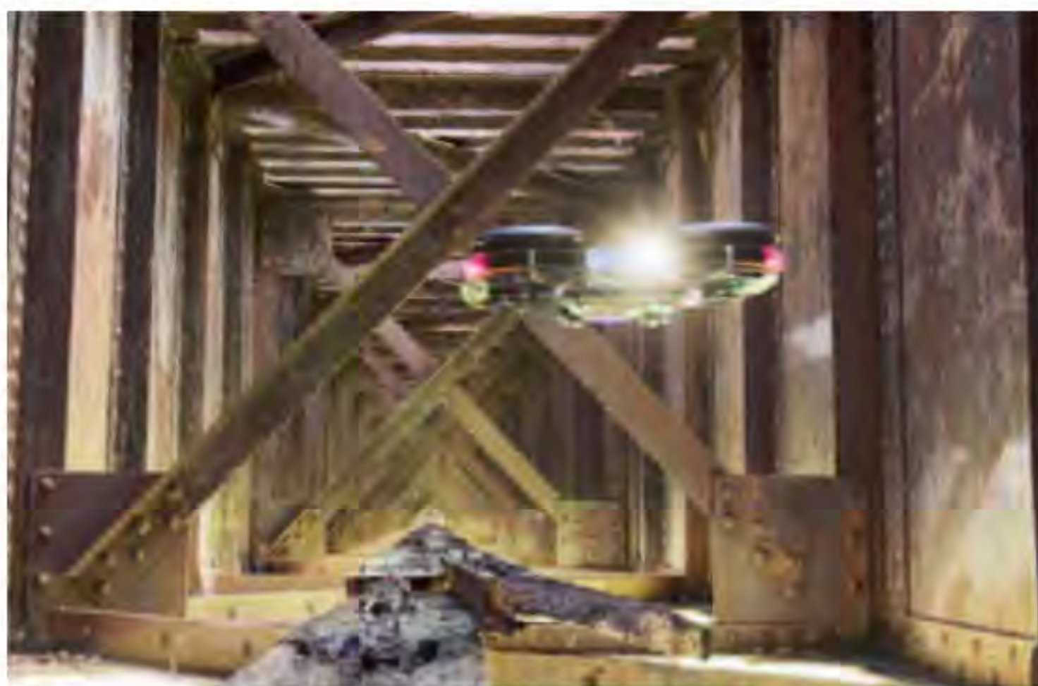
Рис. 4. Работа дрона в ограниченном пространстве
