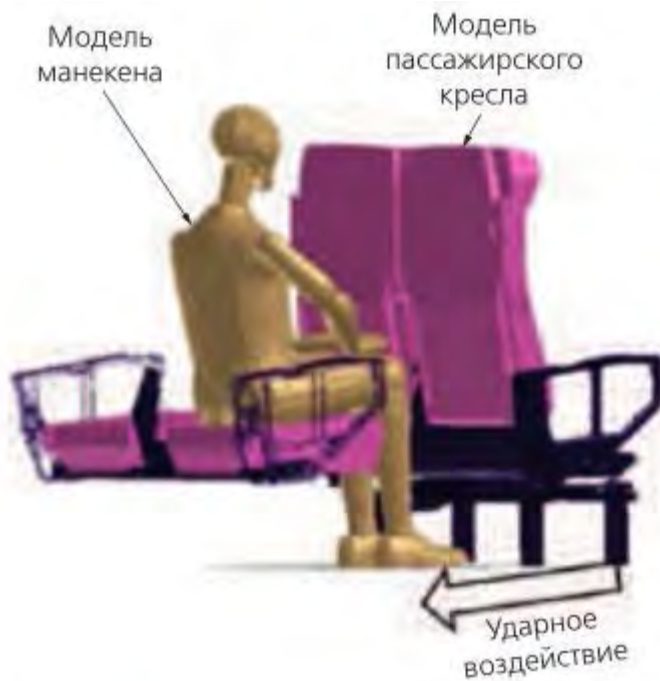
Рис. 3. Моделирование возможного травмирования пассажира
