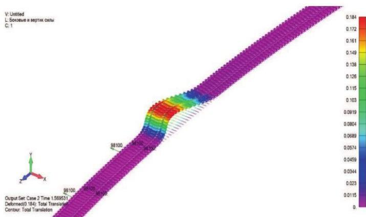
Рис. 4. Графическое отображение резкого искривления рельсошпальной решетки радиусом 250 м при одновременном воздействии поездной и температурной нагрузок (для наглядности перемещения увеличены в 10 раз)
