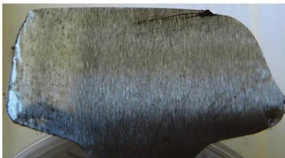
Рис. 5. Профиль головки рельса с трещиной контактной усталости (сечение рельсовой нити с максимальным волнообразным износом)
