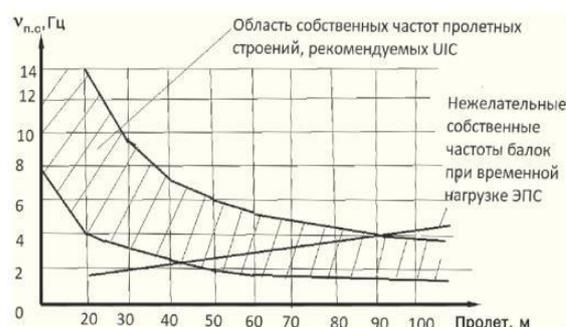
Рис. 2. Нежелательные собственные частоты пролетных строений мостового сооружения
