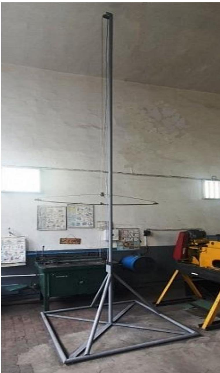
Фото 1. Стенд по контролю образования гололеда на проводах контактной сети
