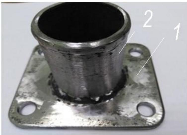
Фото. Металлический фланец радиатора системы охлаждения
