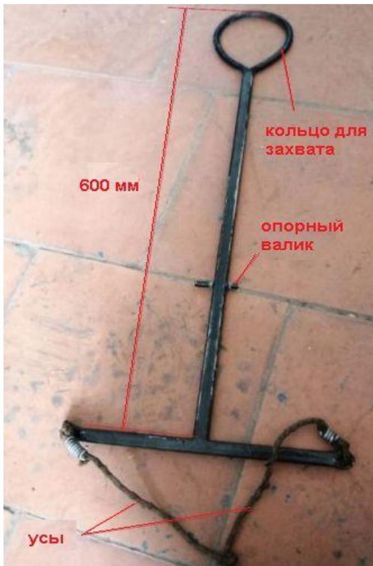
Фото 2. Часть приспособления для установки страховочного каната
