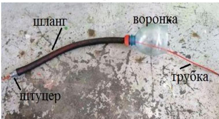
Рис.3 Усовершенствованное приспособление для доливки масла
