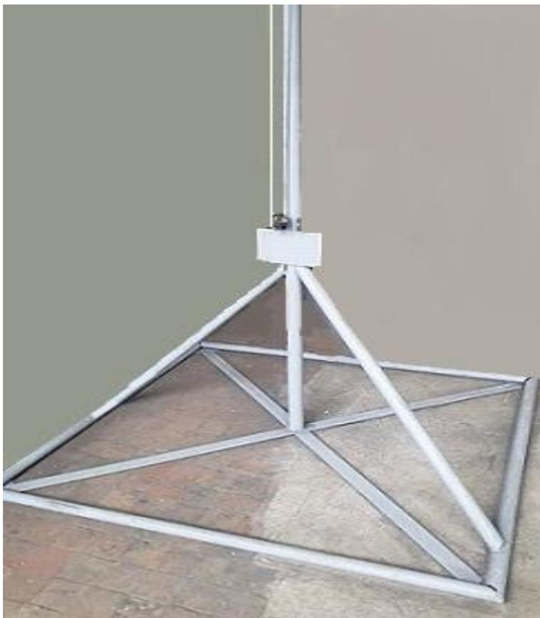
Фото 2. Стенд по контролю образования гололеда на проводах контактной сети (основание)
