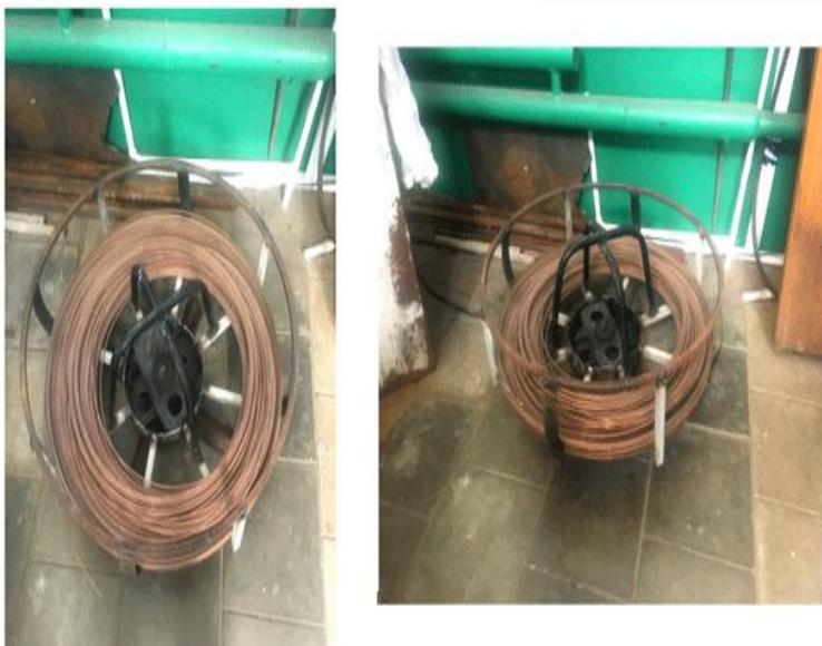
Фото. Внешний вид барабана для раскатки провода.
