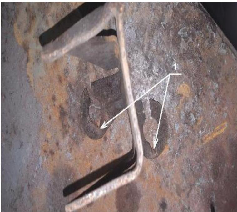
Фото 1. Изношенная деталь стойки фиксатора
