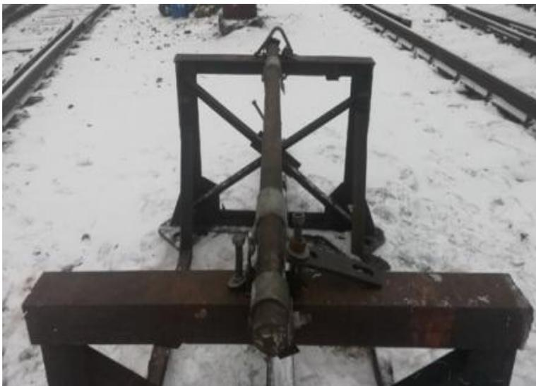
Фото 2. На фото 1,2 показано использование основания металлической опоры для установки барабана с контактными проводами на АДМ.
