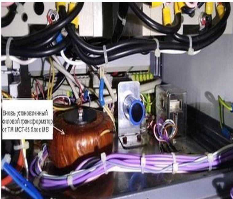
Фото 3. Вид измерительного блока NSF-7 ЛИК-2М с вновь установленным силовым трансформатором типа А340.01.05.120 из блока питания МВ от системы ТМ МСТ-95
