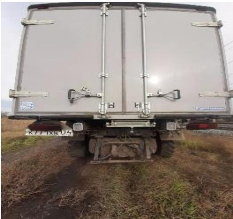
Рис.2 Дополнительные отбойники установленные к дверям автомобиля
