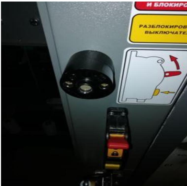
Рис. 3. Блок-замок электромагнитной блокировки
