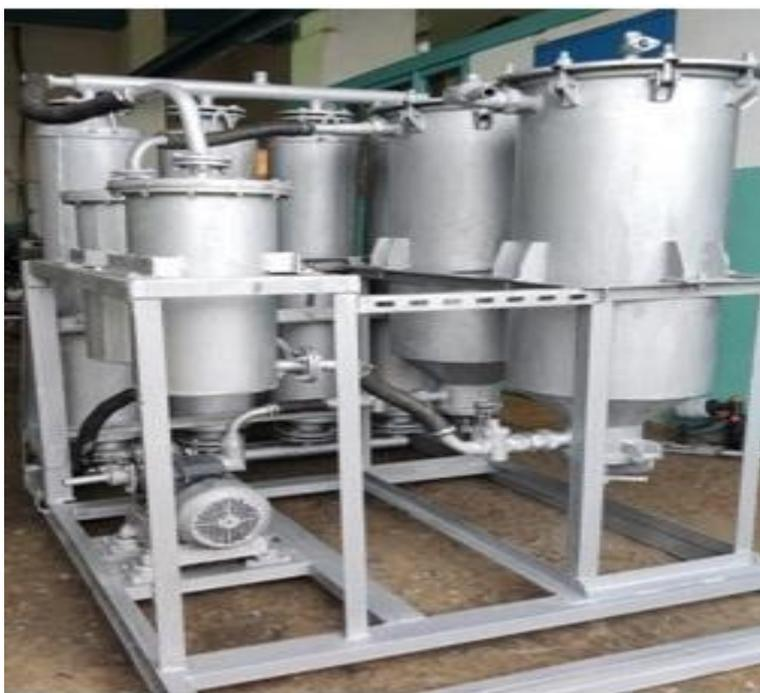
Фото 1. Передвижная цеолитовая установка для регенерации трансформаторного масла от влаги и механических примесей ПЦУМ-1 (общий вид)
