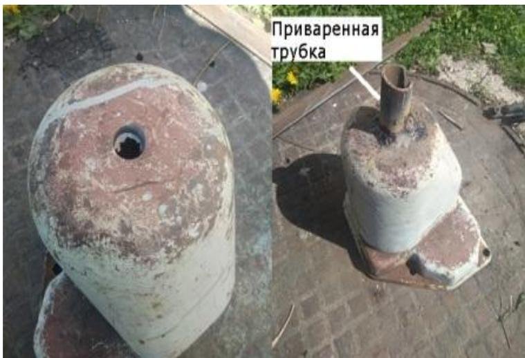
Фото 2. Колпак с просверленным отверстием и приваренной трубкой
