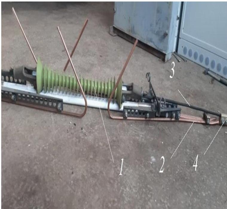
Фото. Механическая страховка изолирующих стержней.
