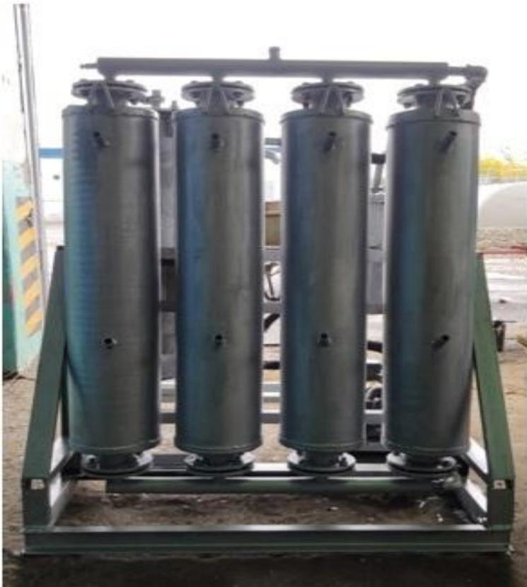
Фото 2. Блок с фильтрующим элементом – цеолит
