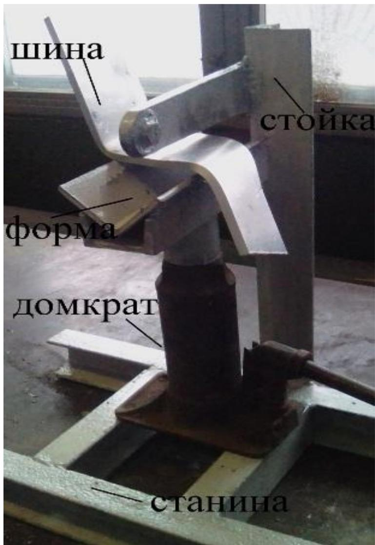
Рис.2 Гидравлический шиногиб для изготовления ошиновки
