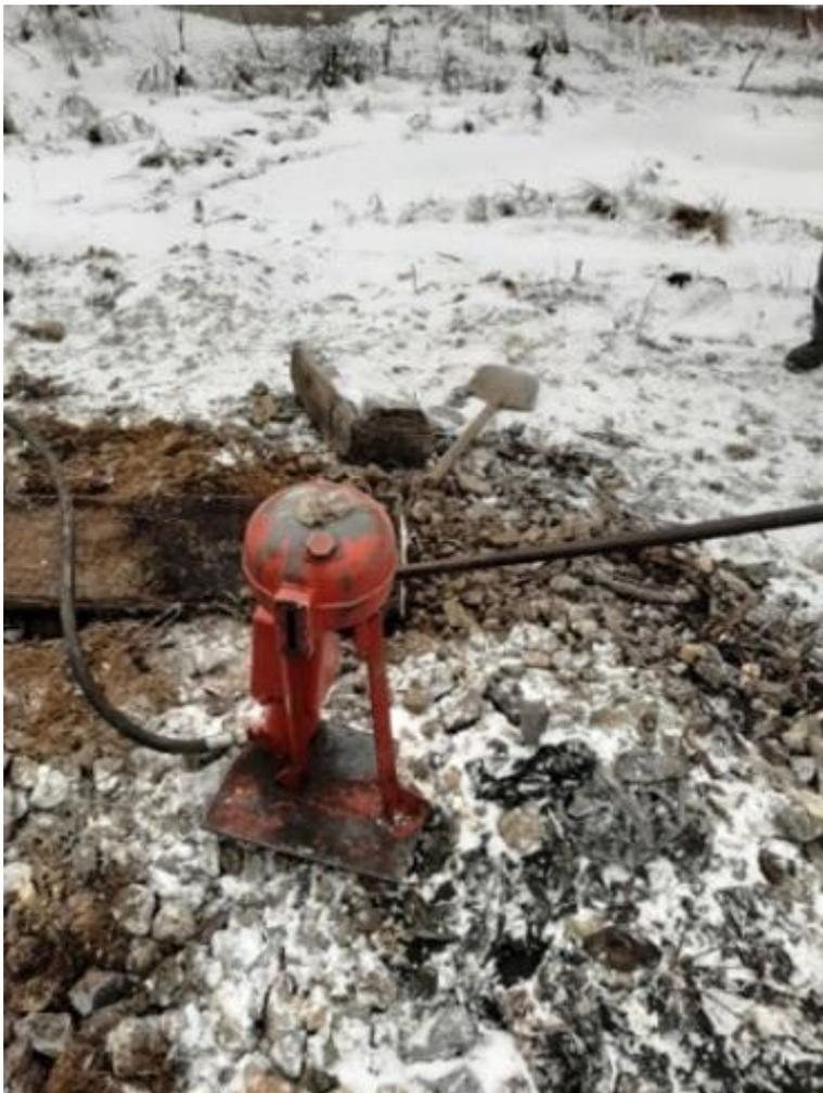
Фото 3. Расширительный масляный бак с ручным приводом для нагнетания давления в устройство
