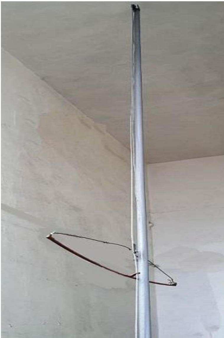
Фото 3. Стенд по контролю образования гололеда на проводах контактной сети (эталон - контактный провод МФ-100)
