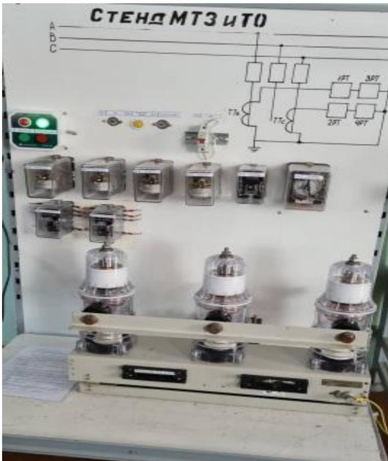
Фото 1. Стенд релейной защиты для наглядного отображения работы токовой отсечки и максимальной токовой защиты.
