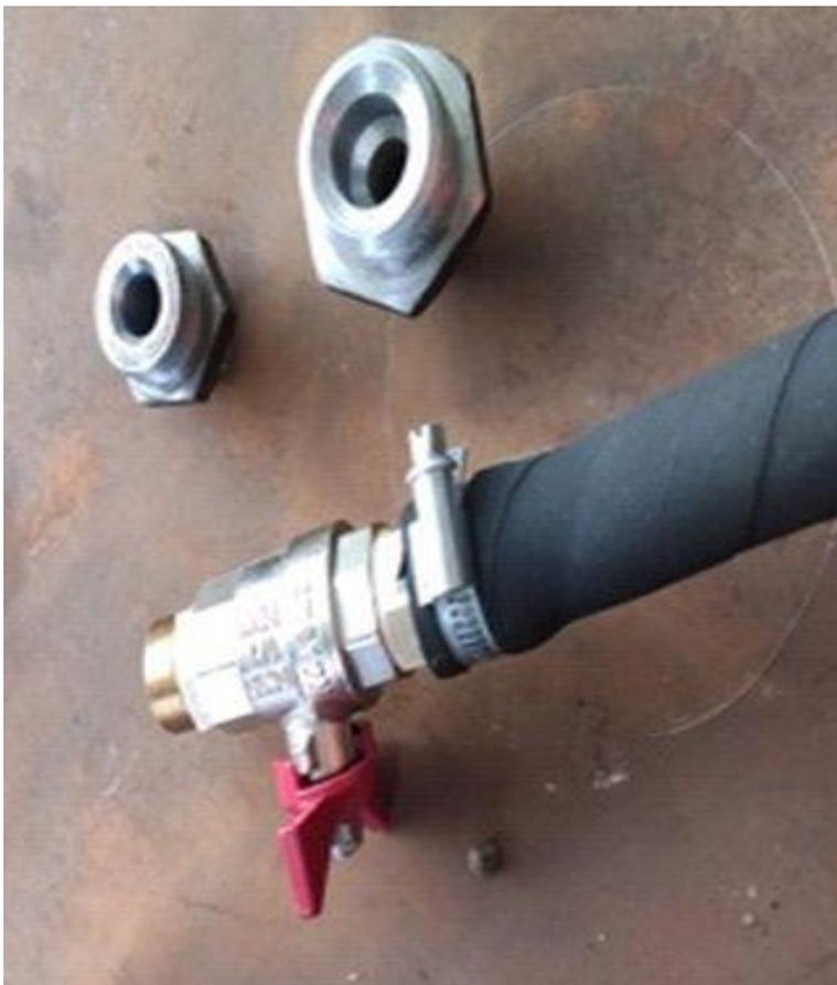
Фото 1. Кран для подключения к оборудованию с переходниками
