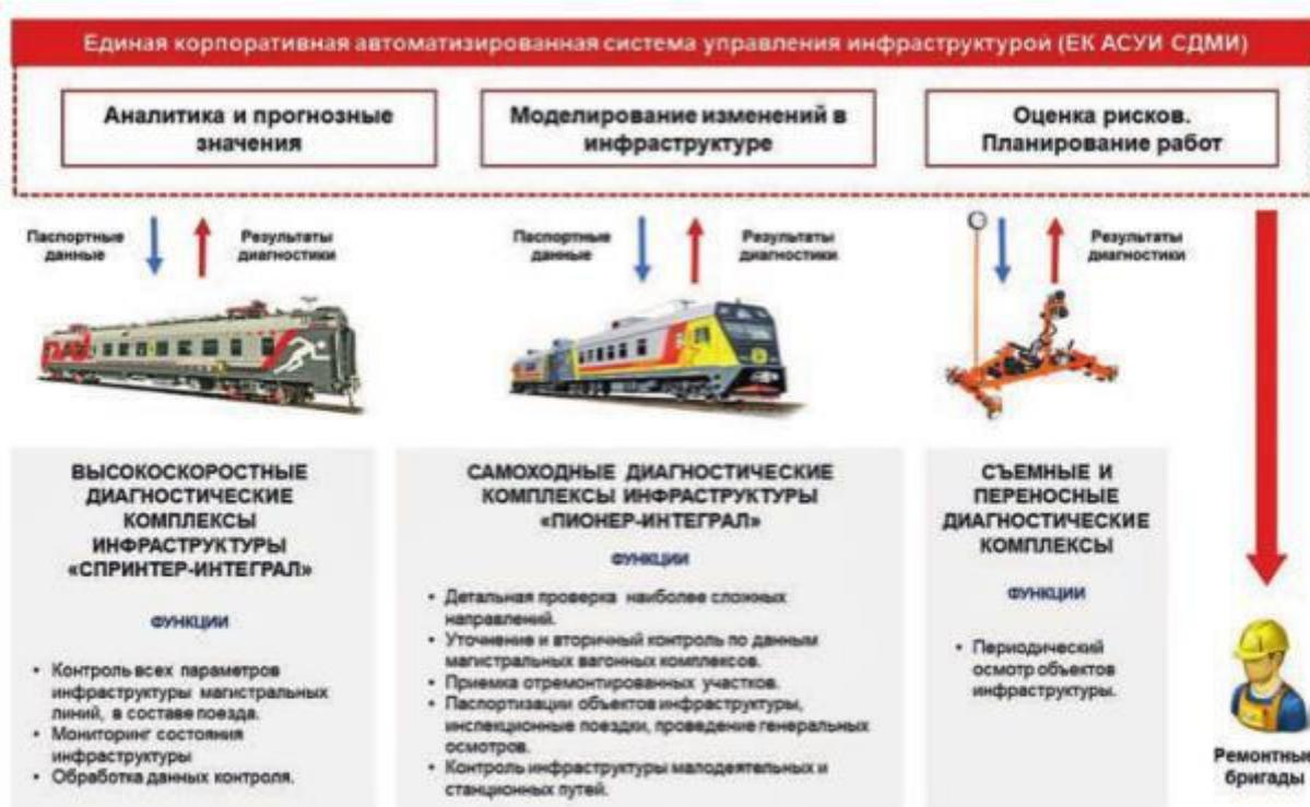
**Рис. 1. Комплексная цифровая полигонная технология диагностики инфраструктуры (работа в составе поезда)**
