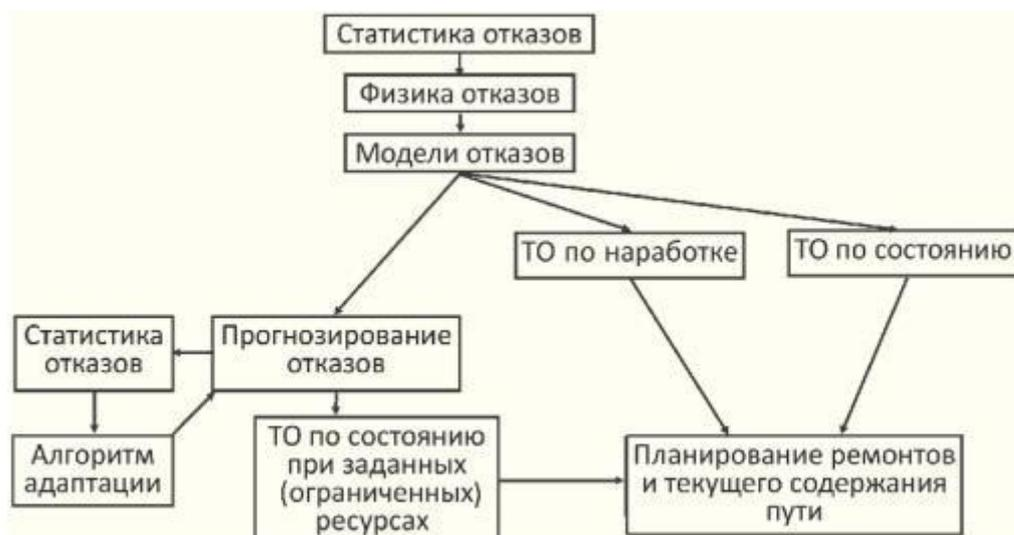
Рис. 1. Блок-схема решения задач технического обслуживания
