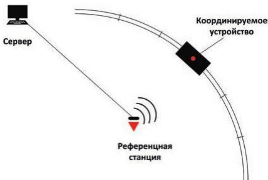
Рис. 3. Схема координирования устройства с помощью референчной станции
