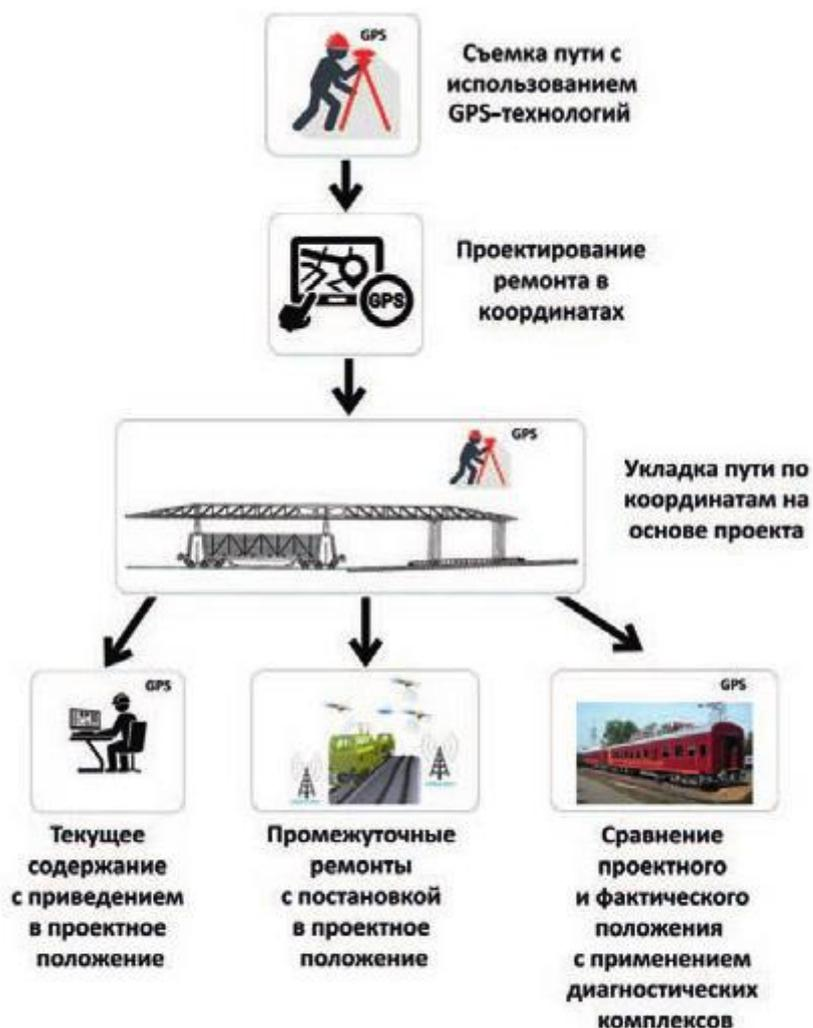
Рис. 2. Основные элементы алгоритма жизненного цикла железнодорожного пути
