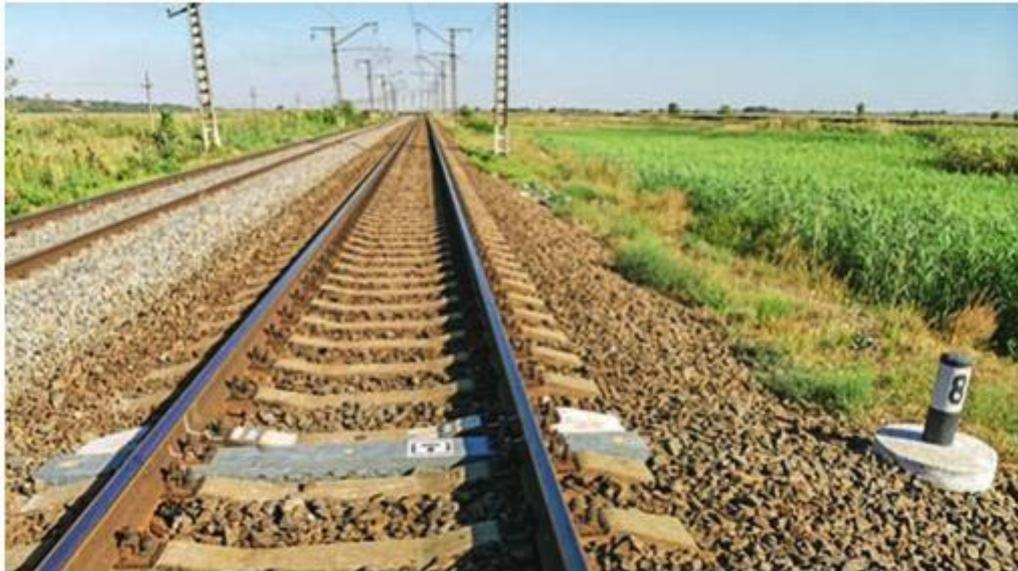
Рис. 5. Композитная пикетная электронная шпала в пути
