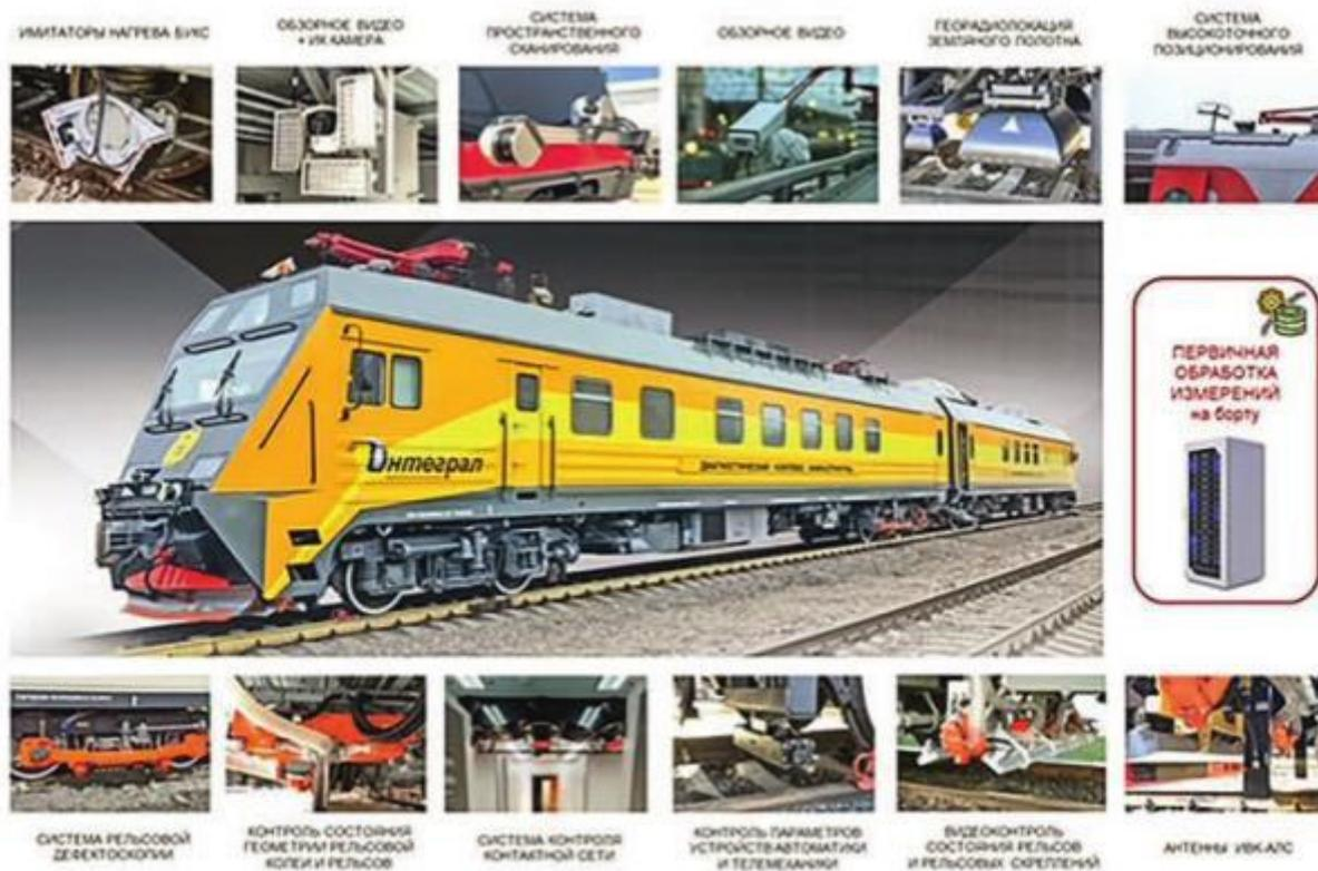
Рис. 2. Размещение диагностического оборудования
