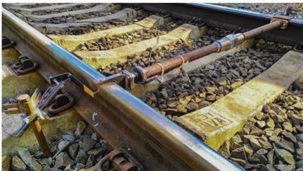
Рис. 1. Общий вид винтовой тяги для создания поперечного нагружения рельсов
