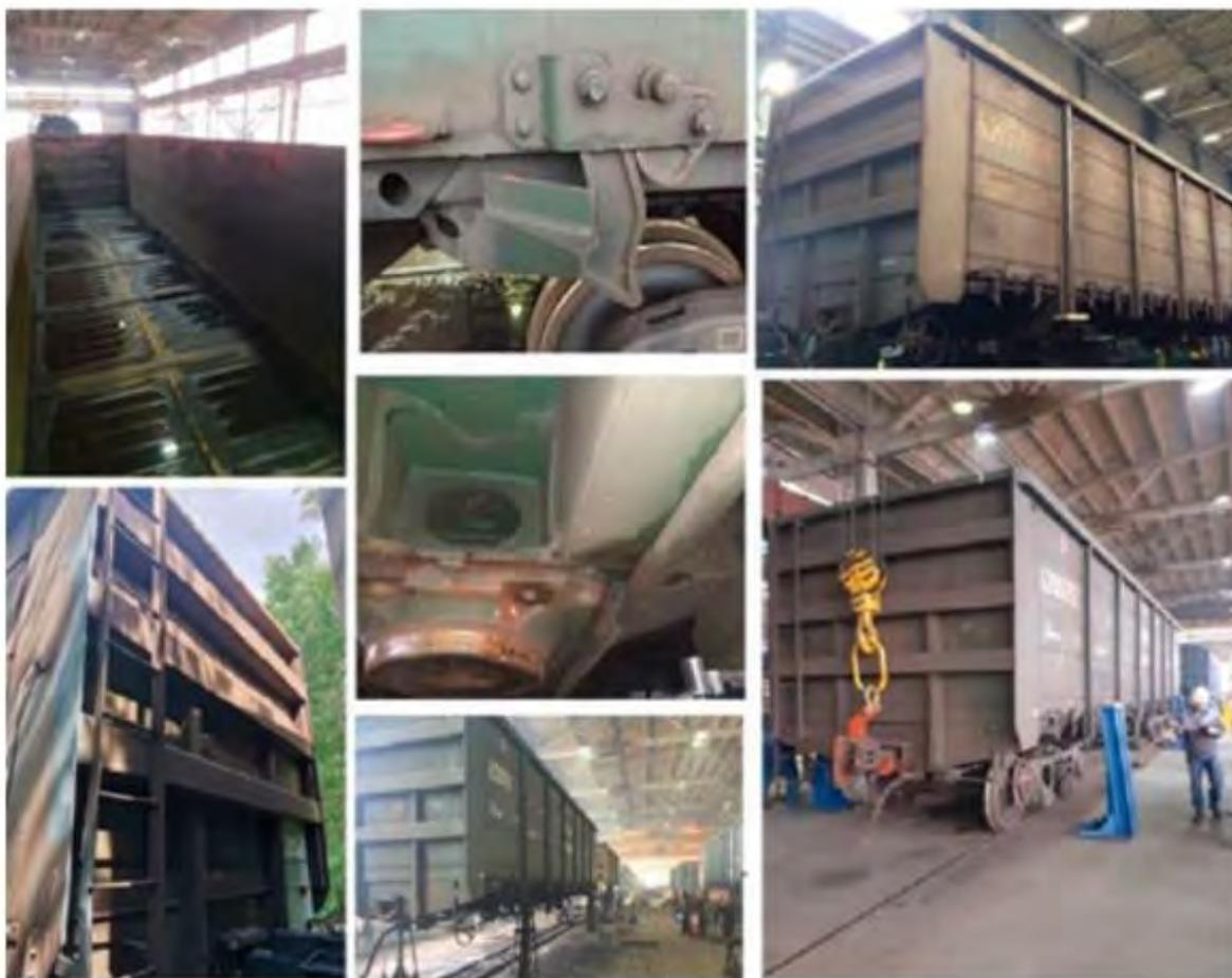
Рис. 7. Состояние кузова полувагона модели 12-9853 с накопленным пробегом 1 млн км
