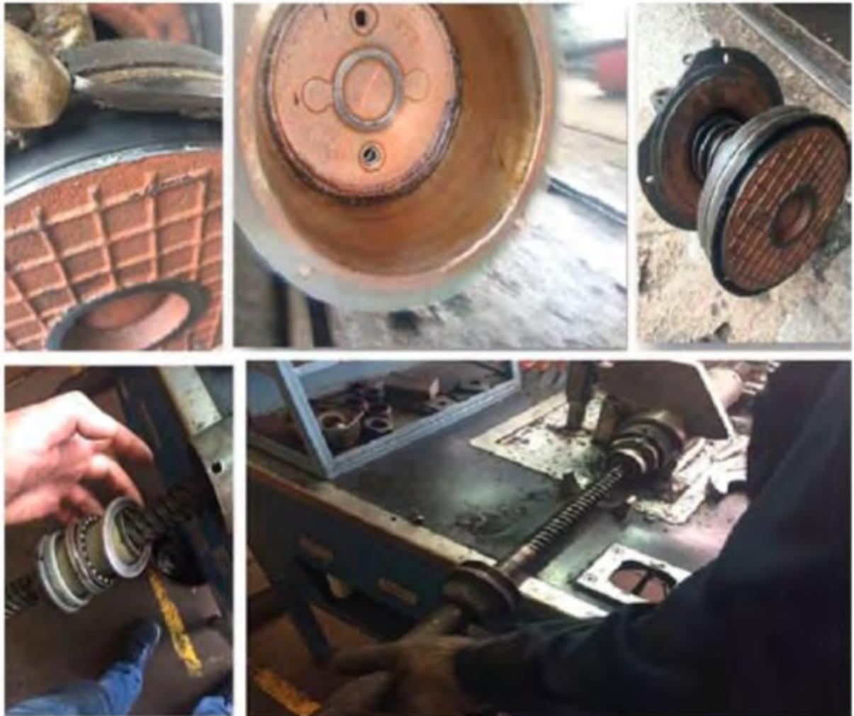
Рис. 9. Тормозное оборудование вагона модели 12-9853 с накопленным пробегом 1 млн км
