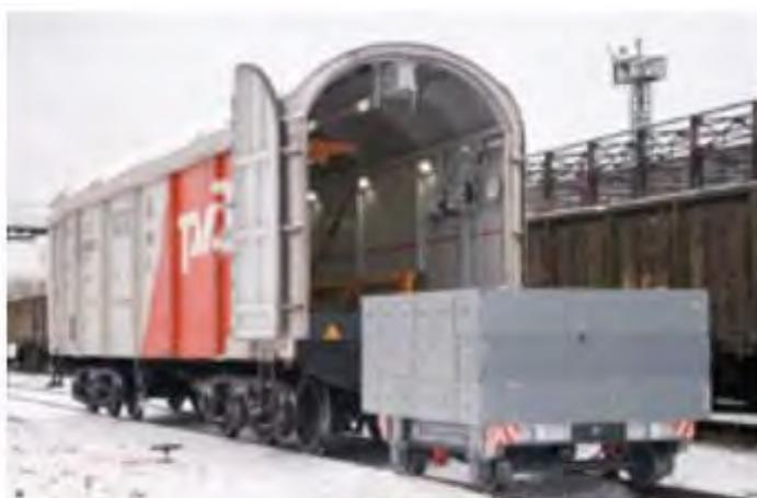
**Шестиосный весоповерочный вагон модели ВПВ-135К грузоподъемностью 89,1 т и осевой нагрузкой 22 тс**
