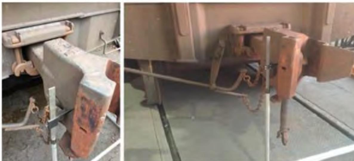
Рис. 8. Автосцепка СА-3 с накопленным пробегом 1 млн км
