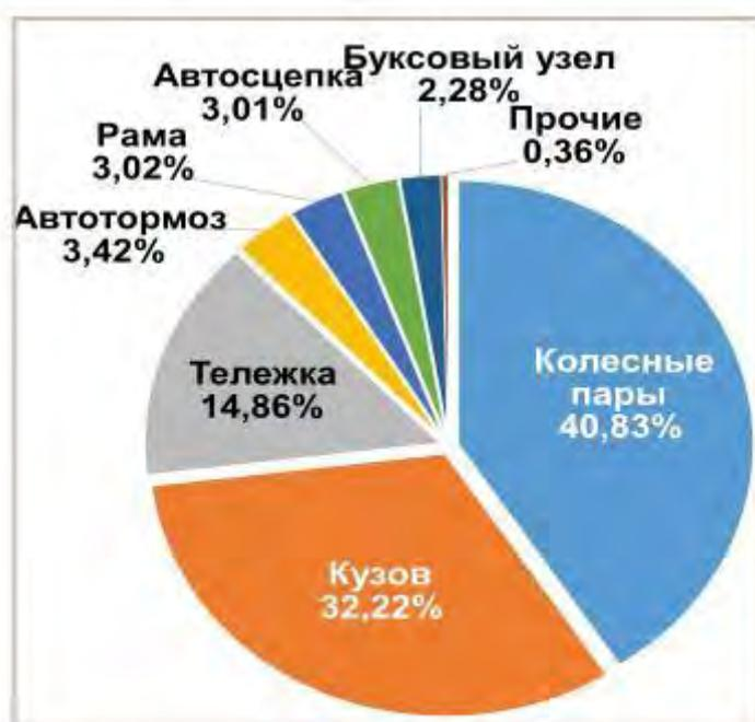
Рис. 2. Распределение отцепок в ТОП вагонов грузового парка РФ по их основным узлам за 2021 г.
