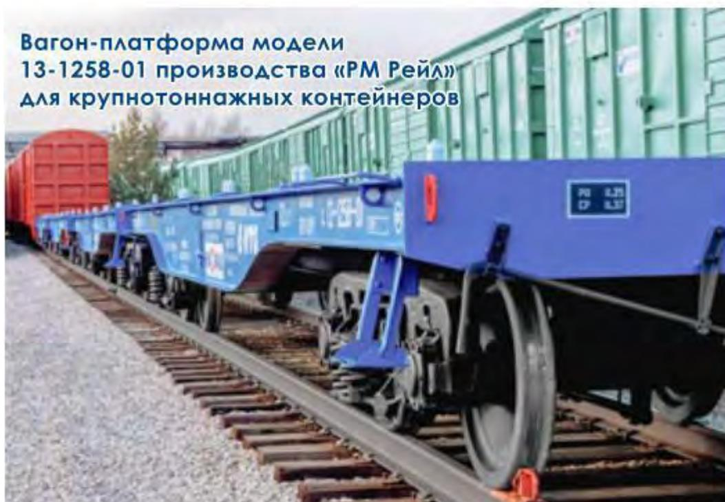
«РМ Рейл» изготовит по заказу VTG Rail Russia 250 вагонов-платформ. Модель 13-1258-01 предназначена для транспортировки контейнеров различных типоразмеров, в том числе массой брутто до 36 т и контейнеров-цистерн с опасными грузами.
