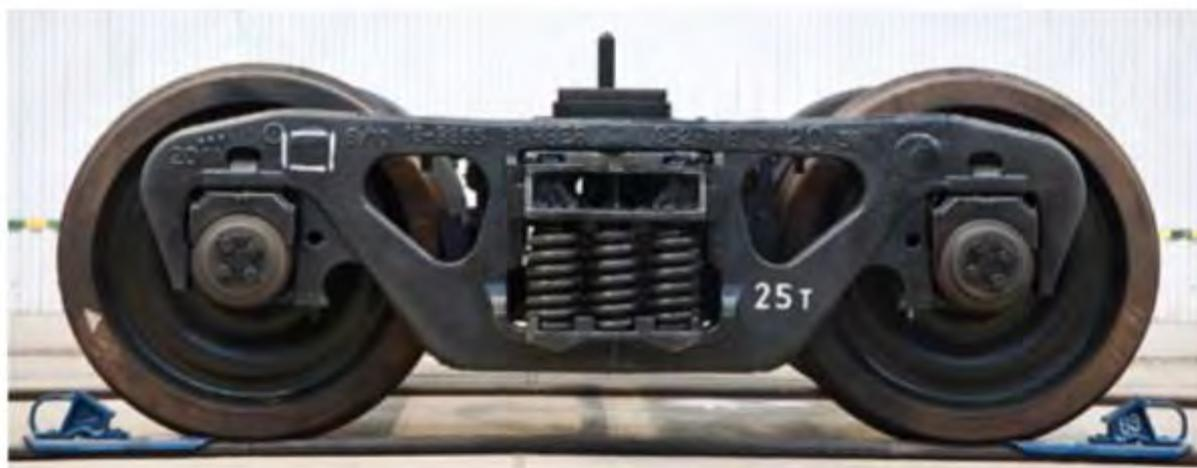
Рис. 2. Тележка модели 18-9855
