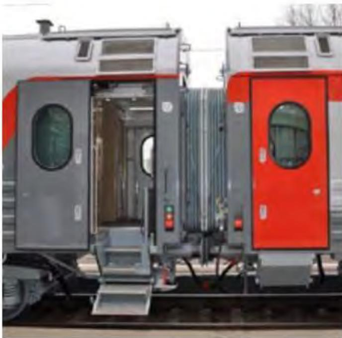
**Рис. 7. Герметизированный межвагонный переход, соединяющий вагоны сцепа**
