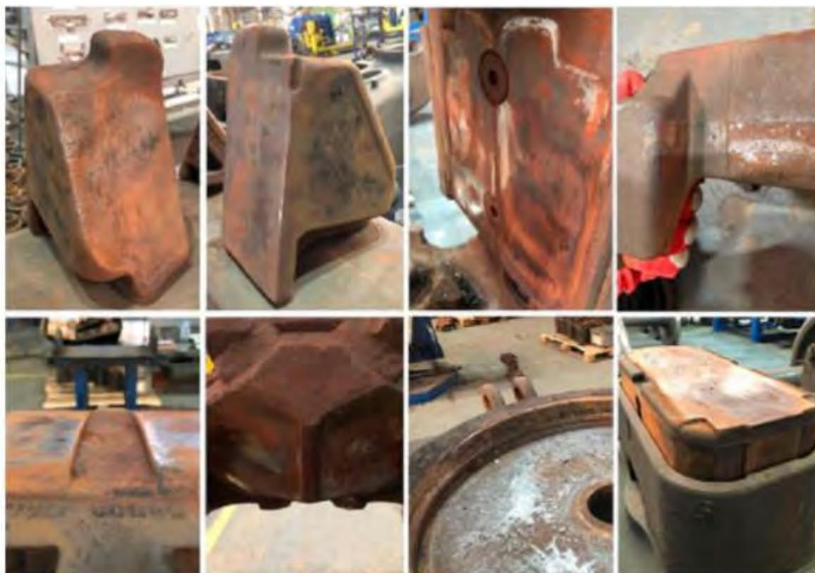
Рис. 6. Состояние деталей тележки модели 18-9855 с накопленным пробегом 1 млн км
