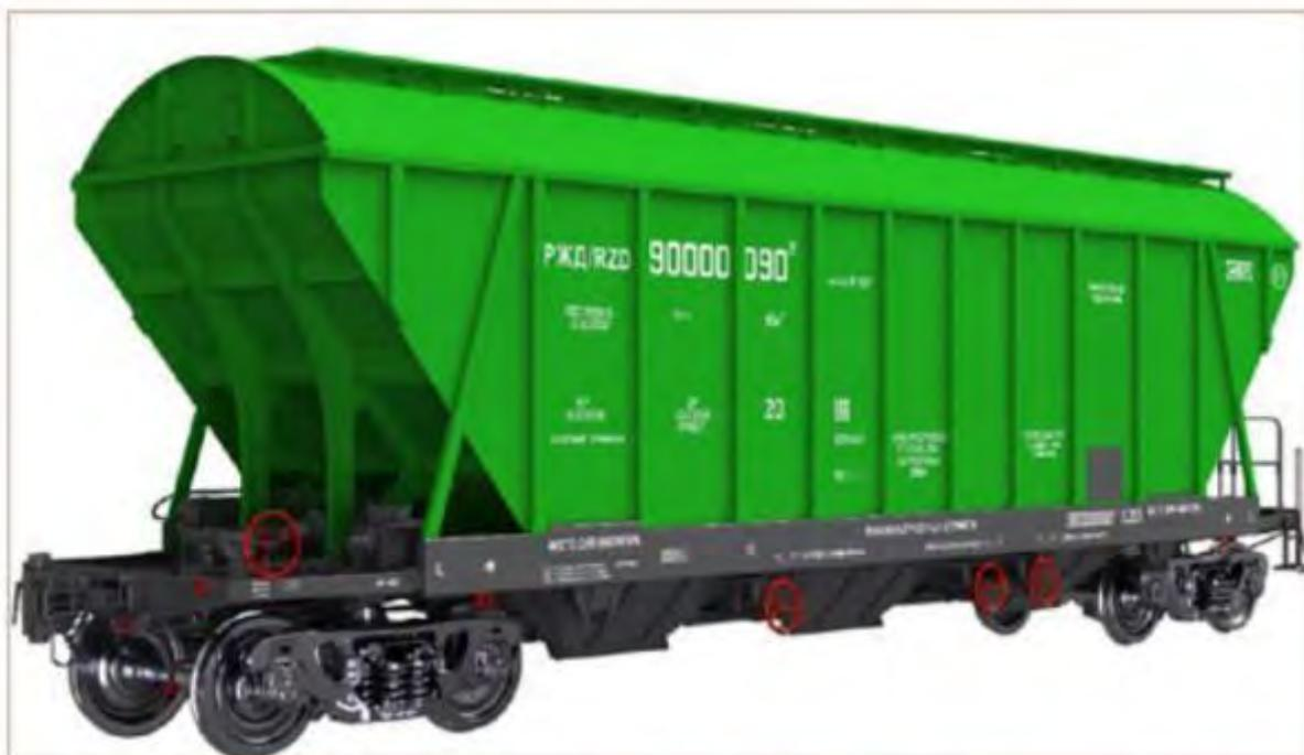
Вагон-хopper модели 19-5217 с объемом кузова 110 м<sup>3</sup> разработки Уральского конструкторского бюро вагоностроения
