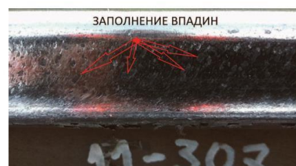
Рис. 3. Точка 11-307. Заполненные смазкой неровности на боковой поверхности головки рельса после прохода одного состава
