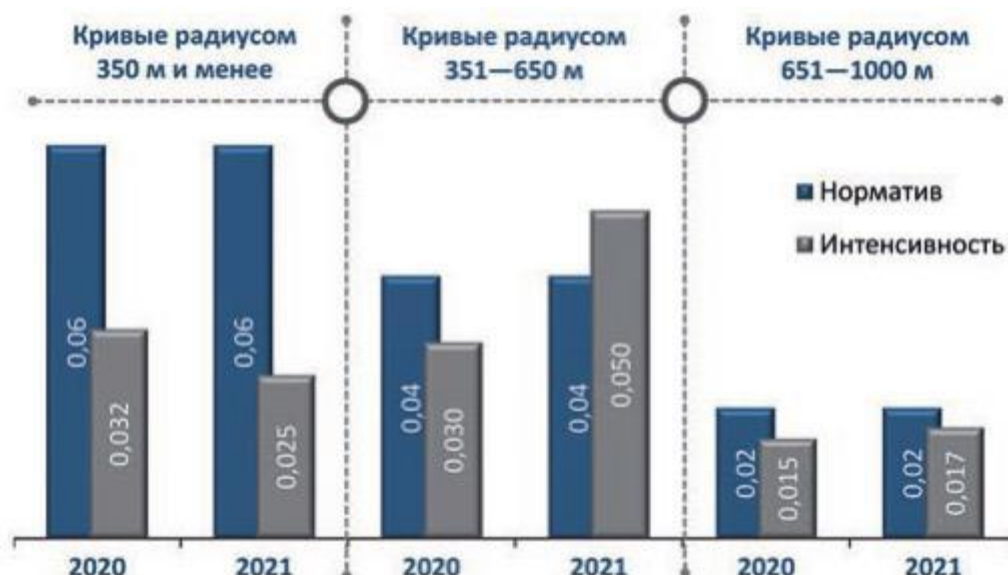
Рис. 2. Интенсивность бокового износа головки рельса, мм/млн т груза брутто, на участках работы вагонов-рельсосмазывателей на полигоне Куйбышевской дороги
