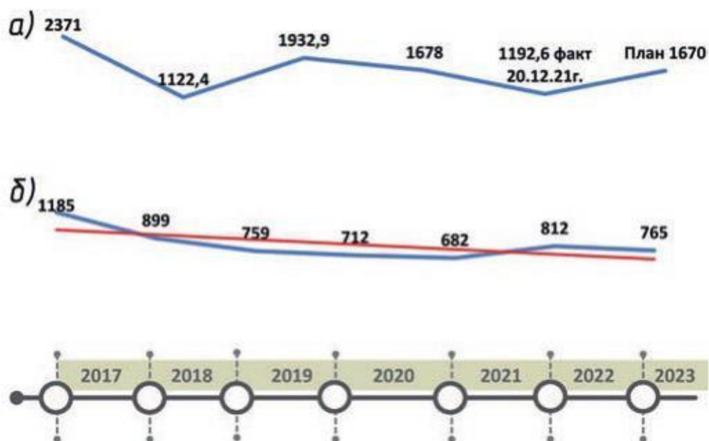
Рис. 3. Выполнение работ по шлифовке рельсов РШП, км проходов, (а) и наличие дефектов 10, 11, 14, 19, 41, 46, шт. (б) в период с 2017 по 2022 г.
