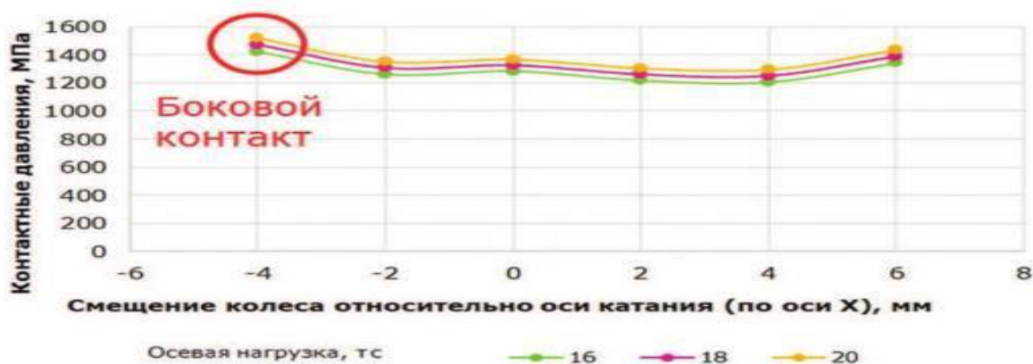
Рис. 6. Контактные давления системы «новое колесо электропоезда «Ласточка»—изношенный рельс Р65» в зависимости от положения колеса относительно оси катания
