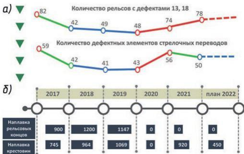
Рис. 4. Кривые зависимости наличия дефектных рельсов от объема выполненных работ, шт., (а) и объемы работ по наплавке, шт., (б) с 2017 по 2022 г.
