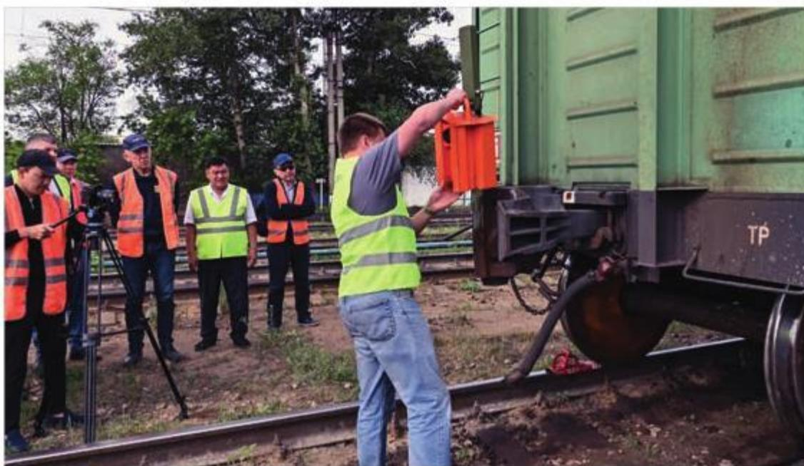
Установка мобильного блока видеоконтроля на автосцепку хвостового вагона
