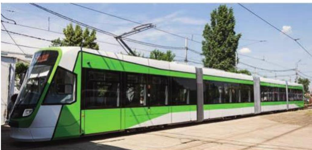
Тяговое оборудование частично поставлено Siemens Mobility, частично местной компанией ICPE- SAERP. В трамвае установлены пять двухстворчатых дверей, которые расположены с одной стороны вагона и оборудованы системой предотвращения падения пассажиров. Также трамвай оснащен системой подсчета пассажиров, информационными дисплеями и видеонаблюдением.
