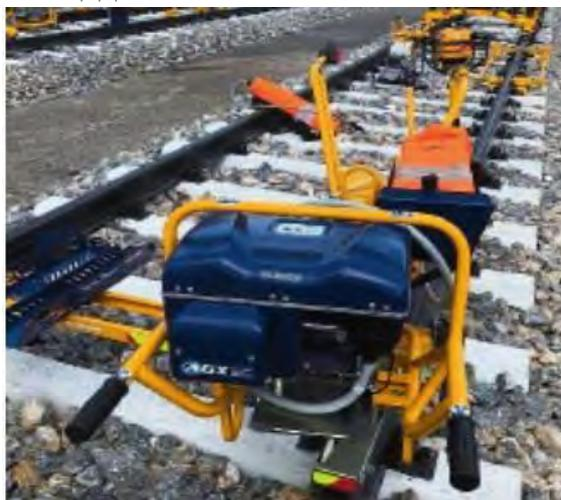
Также компания **Geismar** продемонстрировала линейку из 11 образцов механизированного путевого инструмента с питанием от унифицированной аккумуляторной батареи **Activion** массой 10 кг, которая обеспечивает мощность 1,4 кВт. Аналогичный инструмент компания **Geismar** выпускает с приводом от двигателя внутреннего сгорания с возможностью переоборудования для работы от аккумуляторных батарей аналогичной мощности, обеспечивающих
