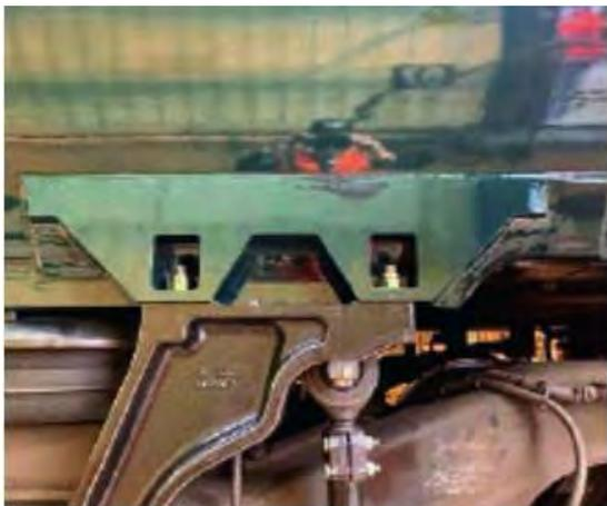
Предварительная оценка позволила прийти к выводу, что можно признать допустимым наличие трещин длиной 620 мм, поскольку исследования показали отсутствие увеличения напряжений, воздействующих на поперечные сварные швы, и опасности дальнейшего распространения трещин на остальную часть сварной конструкции. Согласно результатам последующего анализа уровни напряжений внутри материала сварного шва могут оставаться ниже значений,
