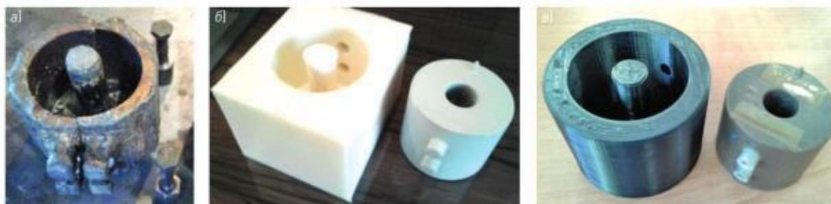
Рис. 6. Формы для изолировки катушек электропневматических вентилях:
