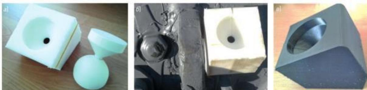
Рис. 7. Оснастка для изолировки головок полюсных болтов тяговых электродвигателей ЭД-118А, ЭД-118Б:
