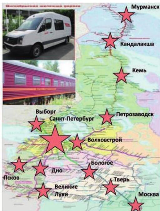
Для поверки (калибровки) средств измерений непосредственно на месте эксплуатации в распоряжении Центра имеются восемь оснащенных эталонным оборудованием передвижных лабораторий на автомобильном ходу и 27 специализированных единиц железнодорожного подвижного состава, в том числе весоповерочные вагоны и метрологические вагоны-лаборатории.
