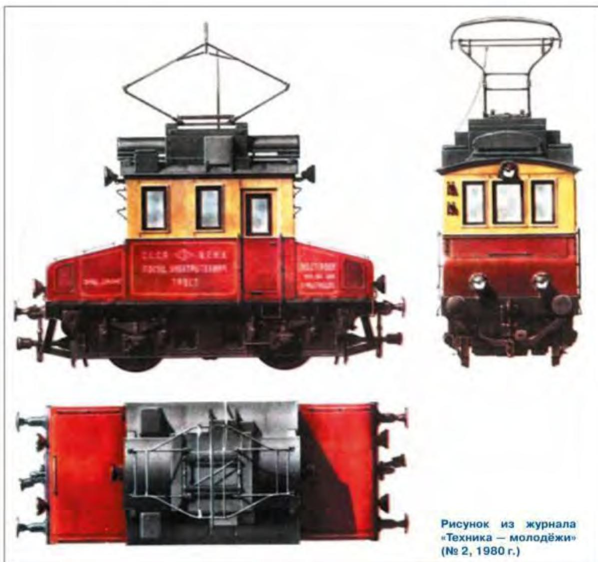
Помимо двух электровозов № 1 и 2, для работы на Электрозаводской ветке в 1932 г. поступили два электровоза «второго выпуска» постройки того же 1932 г. [3]. Они имели широкую кабину и механическую часть Подольского завода. На подъездных путях Электрозавода им присвоили «местные» номера 3 и 4. По утверждению одного моего знакомого, в годы эксплуатации на раме электровоза № 4 читались выбитые в металле цифры «35», но к моменту поступления его в музей никаких клейм уже не было найдено.
