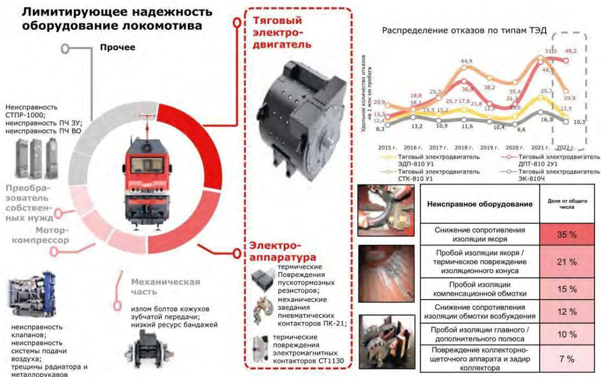
Рис. 1. Оборудование, лимитирующее надежность электровоза 2ЭС6
