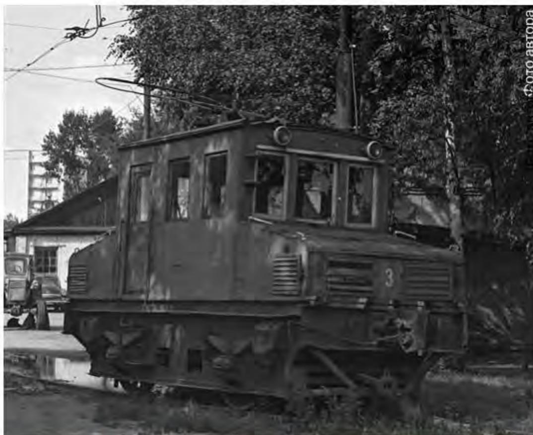
**Электровоз 0-2<sub>0</sub>-0 ГЭТ с «узким» кузовом на вагоноремонтном (трамвайно-ремонтном) заводе в Нижнем Новгороде (июль 1991 г.)**
