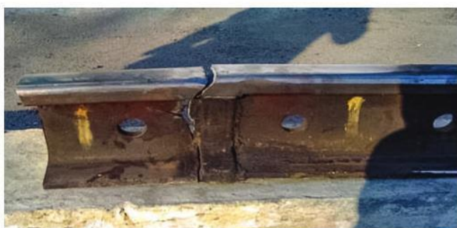
Рис. 1. Поперечный излом рельса по алюминотермитному сварному стыку на перегоне Каменоломни—Персиановка Северо-Кавказской дирекции инфраструктуры
