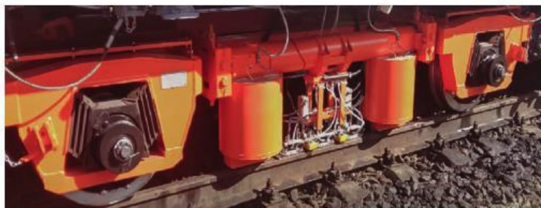
Рис. 2. Намагничивающая система на специализированной дефектоскопной тележке
