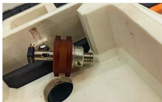
Рис. 3. Силиконовый ролик, совмещенный с энкодером
