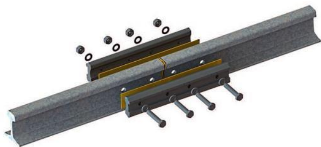
Рис. 1. Изолирующий рельсовый стык с рельсовыми накладками и клеящими веществами
