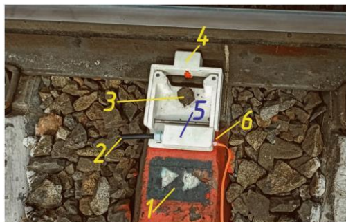
Рис. 2. Устройство контроля сдвигов рельсовых плетей КСТП-01: 1 – «маячная» шпала; 2 – кабель СЦБ 220 В для передачи информации; 3 – шуруп рельсового скрепления ЖБР-65Ш; 4 – корпус для установки силиконового ролика с энкодером для определения подвижек; 5 – место установки платы «ARDUINO»; 6 – USB-выход
